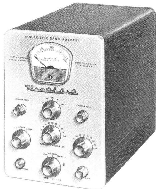
L'adattatore Heathkit modello SB-10 per la soppressione di una banda laterale di modulazione è stato realizzato quale accessorio del trasmettitore « APACHE » modello TX-1.
