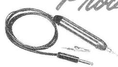
La sonda per R.F. n. 309-C unita ad un voltmetro a valvola con 11 M.Ohm di resistenza di entrata, permette la misura di tensione a R.F. con una precisione del più o meno 10% sino a 250 Mega Hertz. Rappresenta pertanto un utile complemento al succitato voltmetro quando si debbano misurare tensioni a R.F. Costruita in alluminio lucido, con terminazione in polystyrene in due tinte, puntale con cavetto di collegamento flessibile, schermato ed a bassa capacità.
