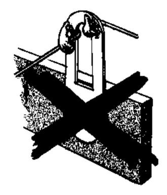
COLD SOLDER JOINT CONNECTION INSUFFICIENTLY HEATED
