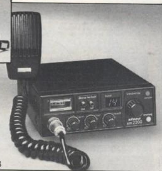
4 Stabo SM 2100/NL Mobilfoon Luxe semi-professionele veiligheids-mobilfoon voor 22 kanalen. PLL-techniek; mikro-elektronika - Kanaalkeuze en kanaalaanduiding op de mikrofoon - Uitgerust met scanner voor vrije of bezette kanalen en 3-toon selectief oproepsysteem - Regelbare ruisonderdrukking; roger-beep - Signaalsterkte-meting d.m.v. LED's - Aansluiting voor combibox - Zacht veiligheidsfront.
