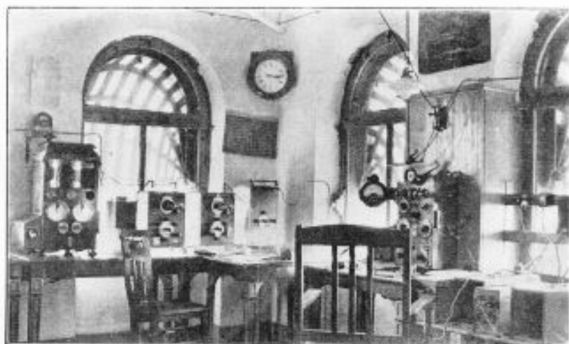
Lampzender op het Telegraafkantoor te Rotterdam.
