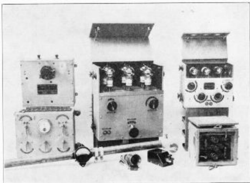
Fig. 3. Fransche radio-installatie voor vliegtuigen (gedeeltelijk).
