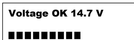
Die Genauigkeit der Anzeige ist ungenau. Der Anzeigefehler liegt oft größer als +/- 0,5V. Anschließend wird das eigentliche Arbeitsmenü angezeigt, das im folgenden Abschnitt 3 (**Impedanz R & X**) näher erläutert wird.
