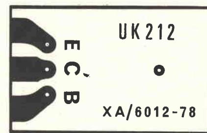
Fig. 3 - CS1 dove verrà effettuato l'ancoraggio dei reofori del transistor di potenza.
