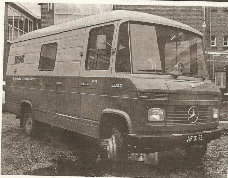
De afgebeelde stereo-reportagewagen heeft de technische dienst van de NOS in 1971 in gebruik genomen. Deze mobiele eenheid, geschikt voor reportages en andere uitzendingen in stereo, bevat een regeltafel met twaalf microfooningangen, drie magnetofoons voor registratie- en montage-doelinden, een televisiecircuit voor visueel contact met de plaats van de opname en een klimaatregeling. Er is ook ruimte voor een zend- en ontvanginstallatie voor een draadloze verbinding met de reporter en omgekeerd. Voor dit laatste doel is een uitschuifbare, hydraulisch werkende, antennemast ingebouwd. De inrichting van deze wagen is verzorgd door de technische dienst van de NOS-radio. In totaal heeft de NOS acht van dit soort wagens in gebruik.
